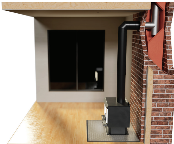
INSTALLATION AVEC CHEMINÉE DE MAÇONNERIE
