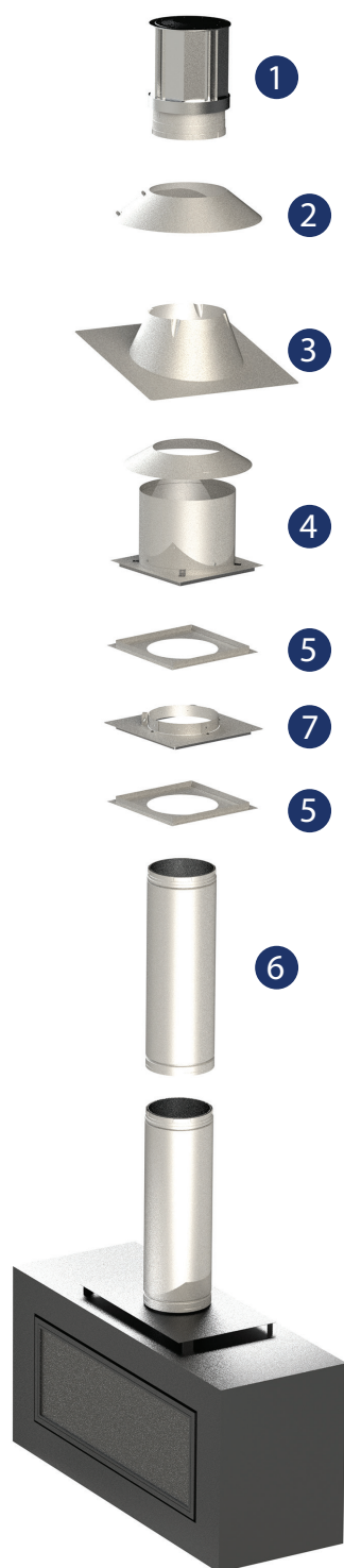
Installation verticale sur deux étages
